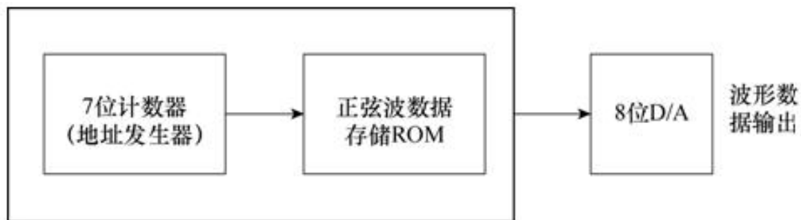
图 6-24 正弦信号发生器结构框图
