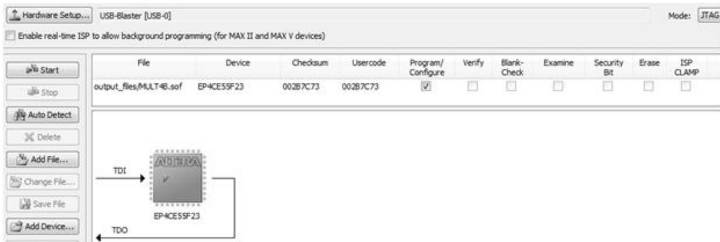
图 4-19 选择 JTAG 编程模式，将 SOF 文件载入 FPGA
