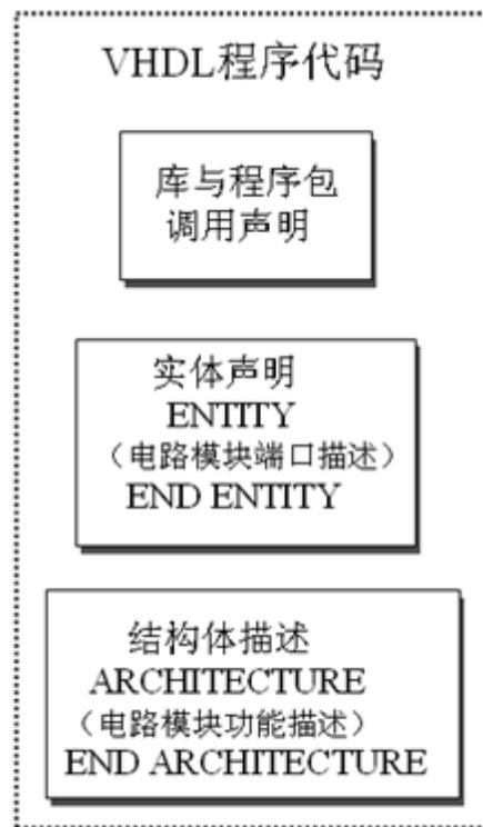
图 3-8 VHDL 程序结构
