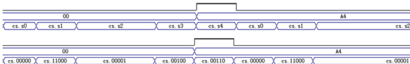
图 10-22 不同状态元素定义状态机的仿真波形
