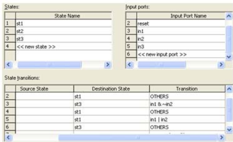
图 10-16 设置状态变量和状态转换条件
