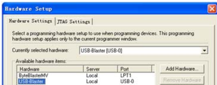
图 4-20 加入编程下载方式
