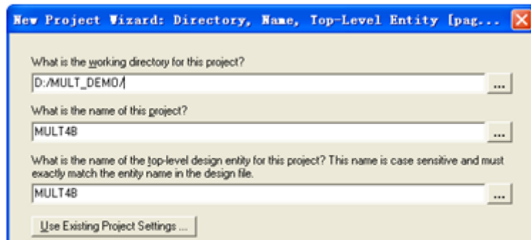
图 4-3 利用 New Project Wizard 创建工程 MULT4B
