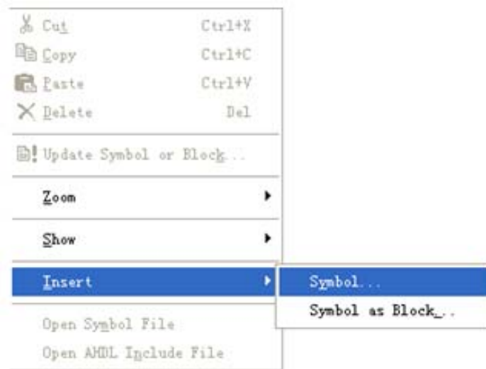
图 4-26 选择打开元件输入窗
