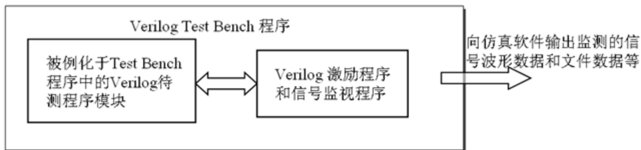
图 14-4 Verilog Test Bench 结构
