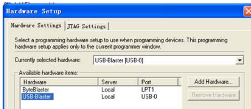
图 2-22 加入编程下载方式
