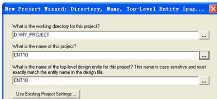
图 2-3 利用“New Preject Wizard”创建工程
