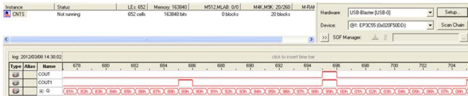
图 2-33 SignalTap II 数据窗口显示实时在系统采用获得的信号数据
