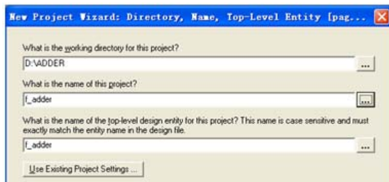
图 4-29 全加器 f_adder.bdf 工程设置
